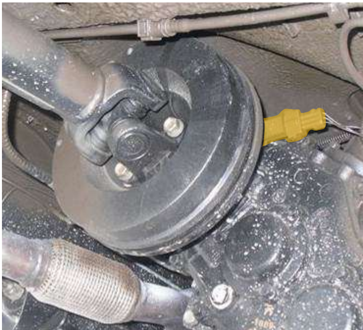
Рис.90. Внешний вид и место установки датчика скорости автомобиля
