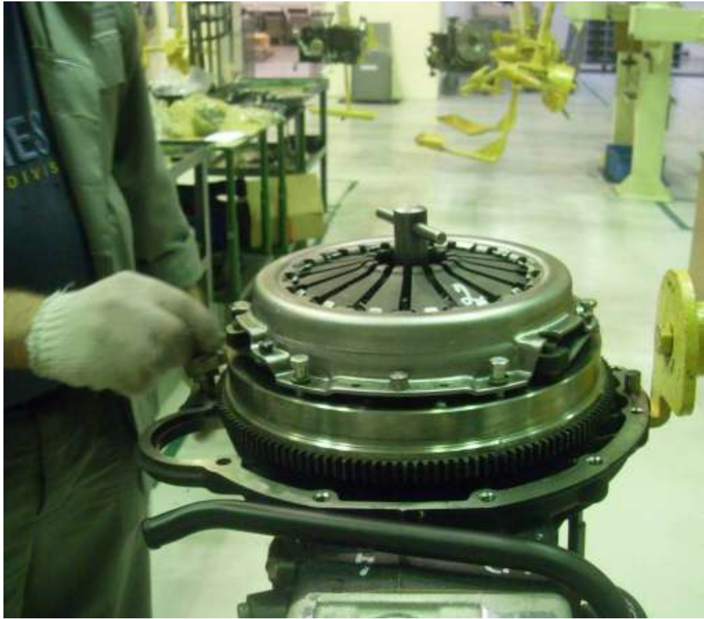
Установка фиксатора коленчатого вала ЗМ 7820-4550
