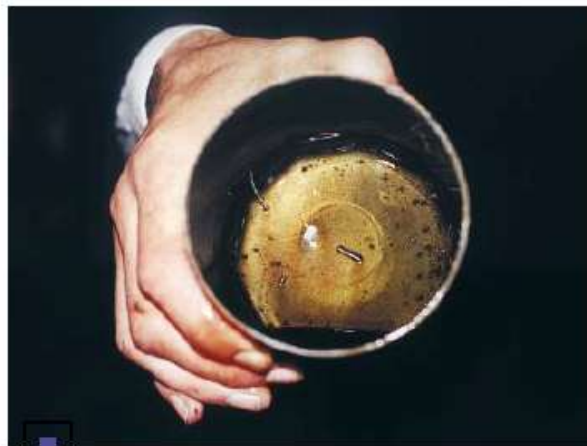
...в его внутренностях обнаруживается «захороненная» стружка
