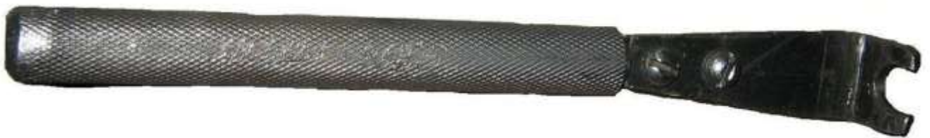
Рис.А.28 – 3М 7823-4655 Оправка для извлечения гидропор из головки цилиндров
