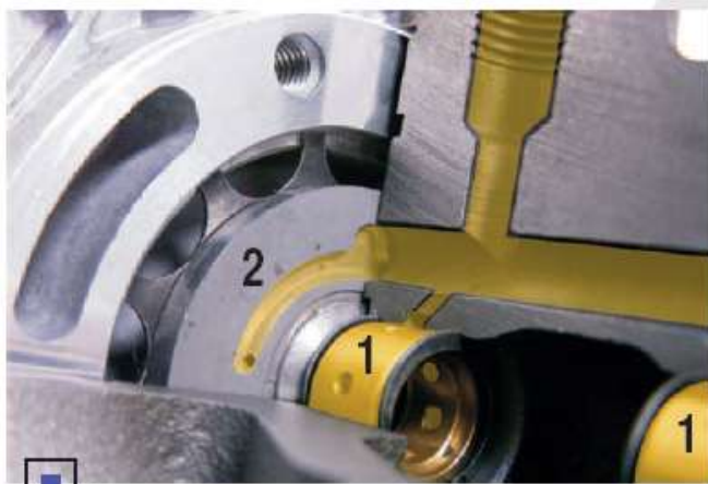
Вал ротора удерживается в центральном корпусе подшипниками скольжения: двумя радиальными (1) и одним упорным (2)
