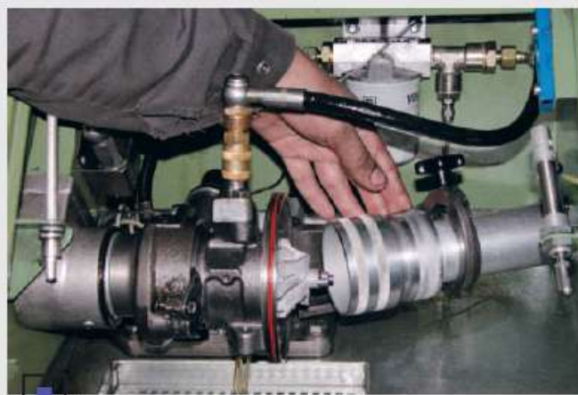
При испытании на стенде Turbotechnics полностью имитируются условия, в которых работает турбина
