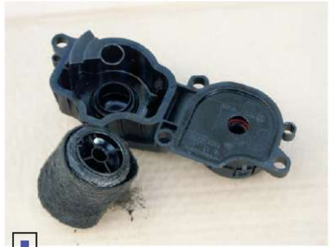
Похоже, фильтр системы вентиляции не менялся с момента его установки на конвейере
