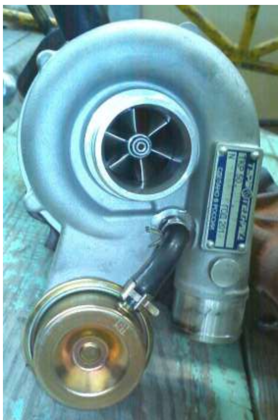
Информация и расположение идентификационной таблички на ТКР 50.04.07
