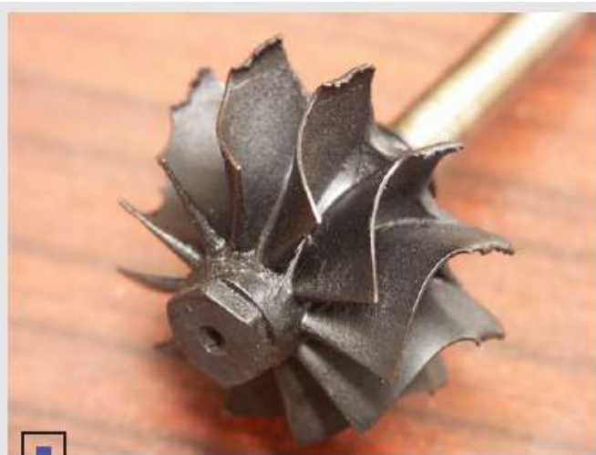
Судя по тому, что повреждены входные кромки турбинного колеса, нечто прилетело из мотора
