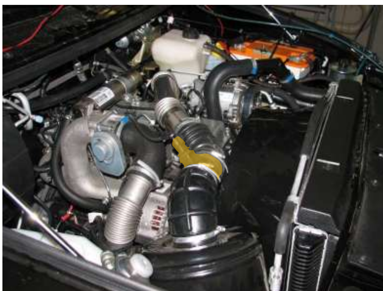
Рис.84. Место размещения ДМРВ в системе впуска
