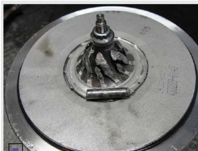
До того как во впуске забыли металлический предмет, это была крыльчатка компрессора
