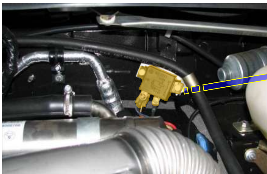
Рис.98. Реле свечей накаливания 16.3777 (3151-48-3747040-00):
