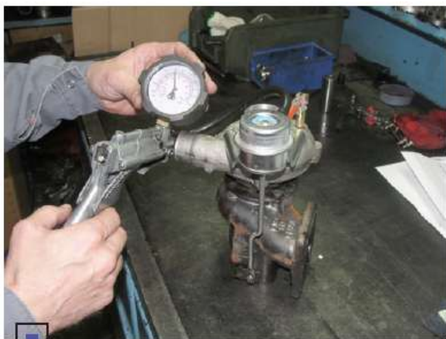
Эксперт проверяет исправность пневматической камеры управления байпасным клапаном
