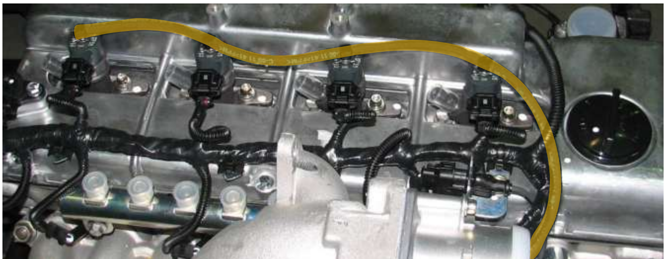
Рис.58. Внешний вид топливопровода отсечного топлива.
