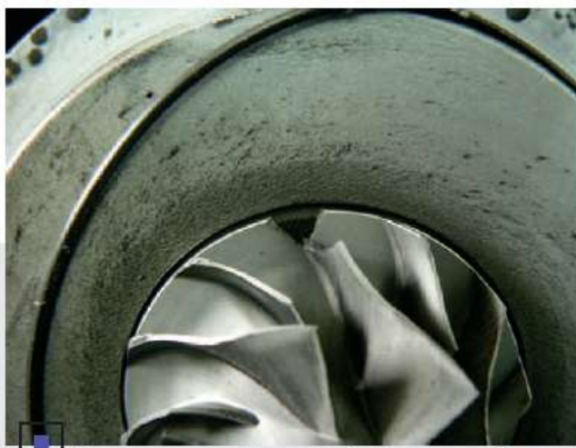
Бывает, лопатки не выдерживают балансировки на рабочих частотах вращения
