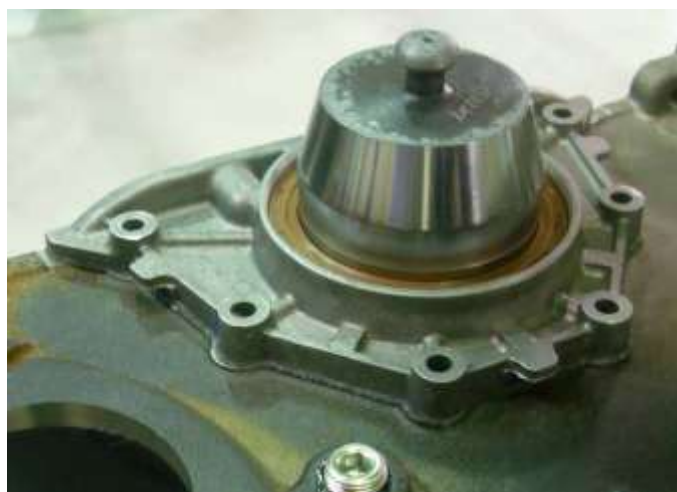
Применение оправки ЗМ 7853-4357 для установки заднего сальника с сальникодержателем на фланец коленчатого вала
