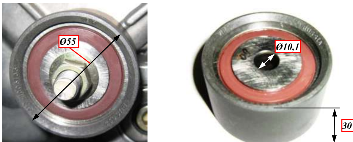
Рис.42. Внешний вид и основные геометрические размеры опорного ролика 3413-1006135 (830700AE3P52Q5/W47-обозначение ЗАО «ВПЗ»)
