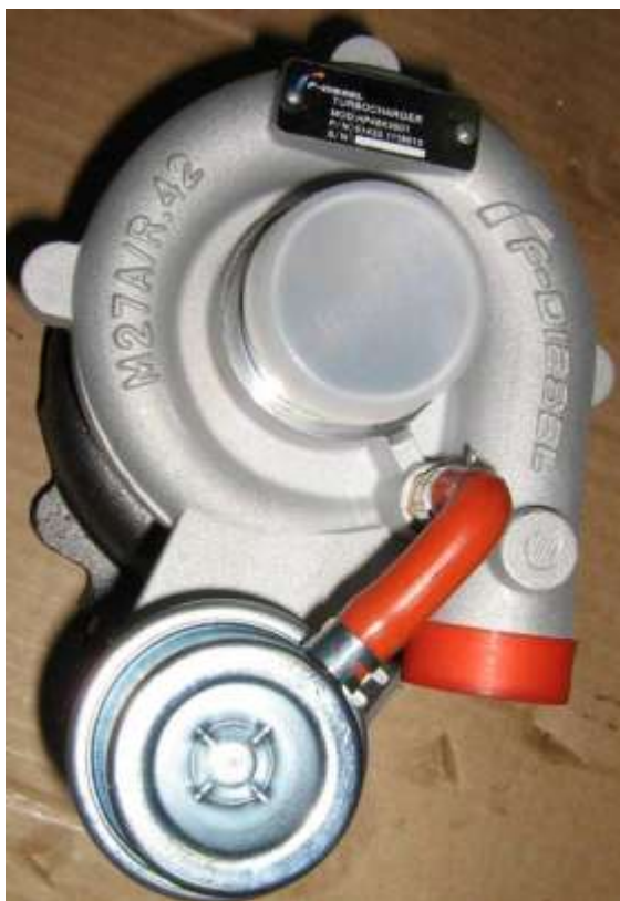
Информация и расположение идентификационной таблички на ТКР HP48X3501
