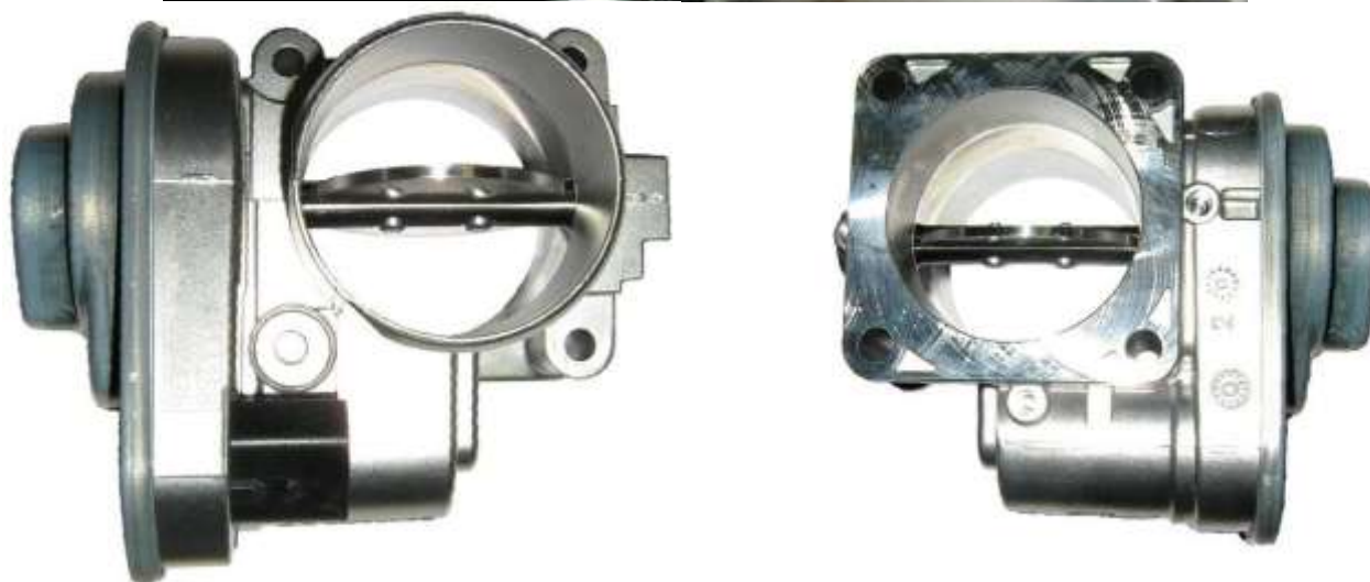
Рис.94. Внешний вид воздухоподающего патрубка с дроссельной заслонкой
