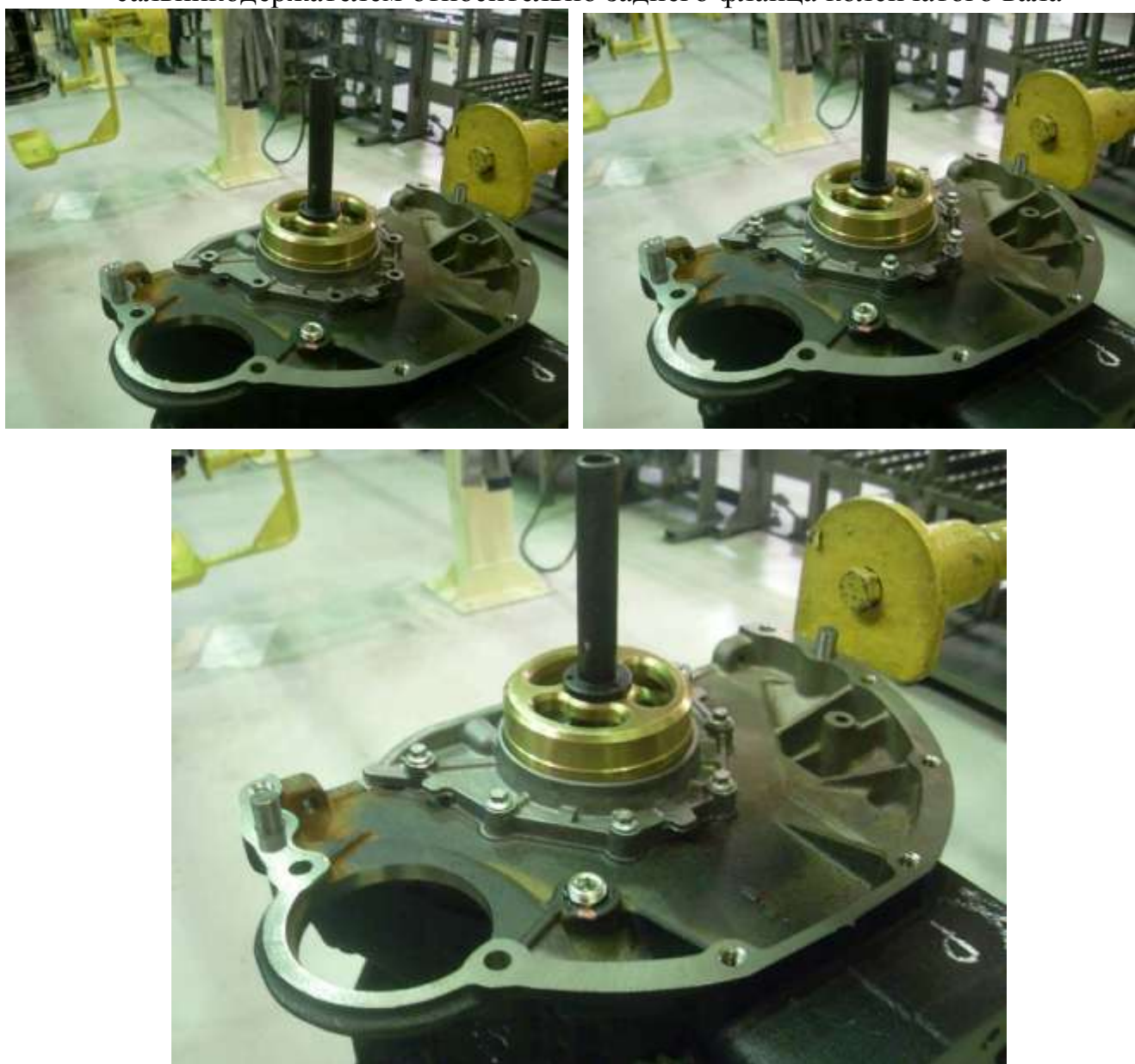
Применение оправки ЗМ 7853-4418 для центрирования заднего сальника в сборе с сальниководержателем относительно заднего фланца коленчатого вала
