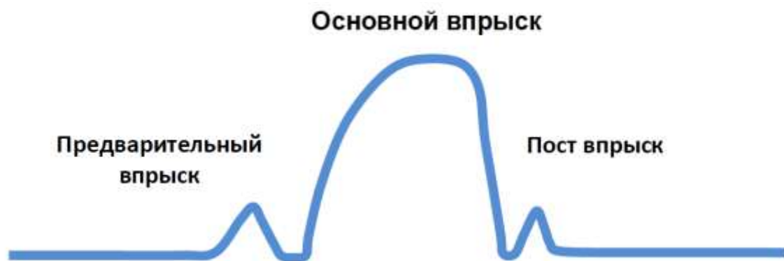
Рис.106. Закон подачи топлива в дизеле ЗМЗ-51432.
