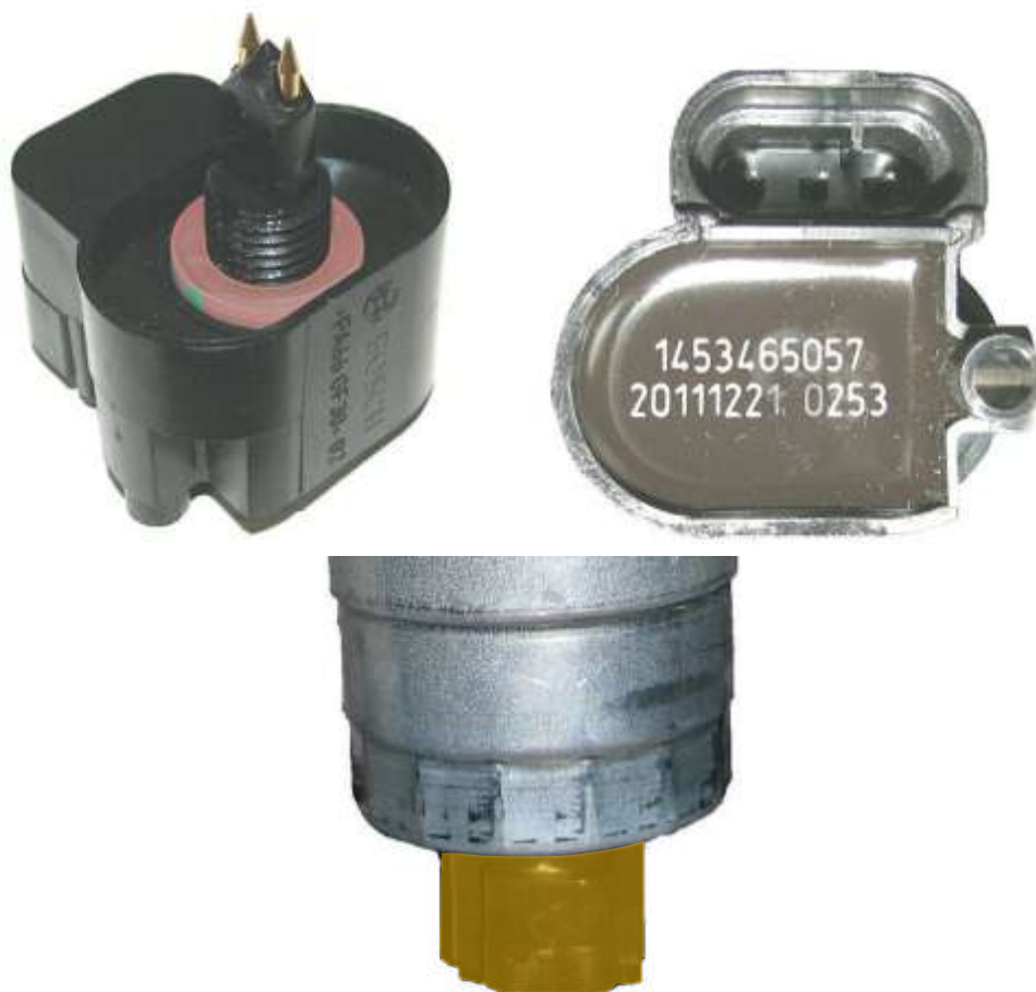
Рис.89. Внешний вид и расположение датчика наличия воды
