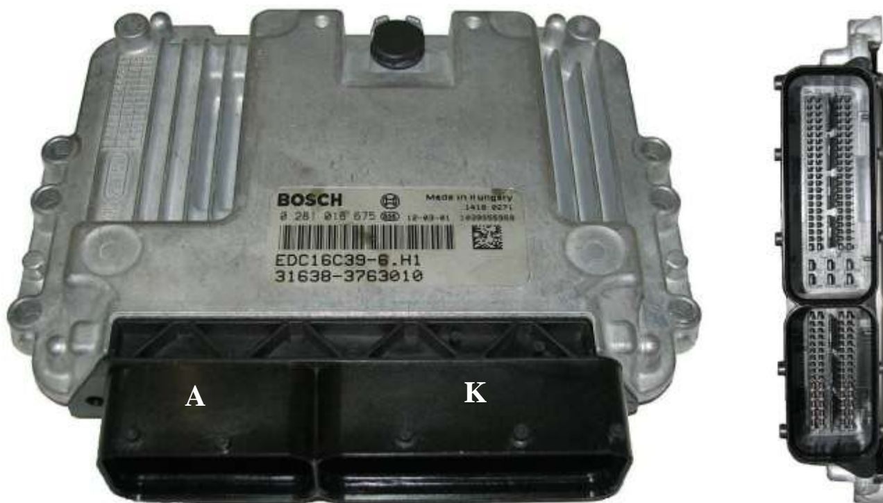
Рис.78. Внешний вид ЭБУ модели EDC16C39-6.H1:
