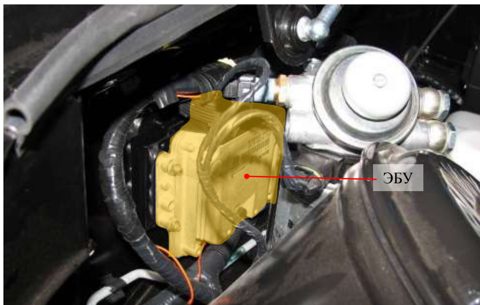
Рис.77. Расположение ЭБУ в моторном отсеке автомобилей УАЗ-31638 Патриот, УАЗ-23638 Пикап, УАЗ-23608 Карго.
