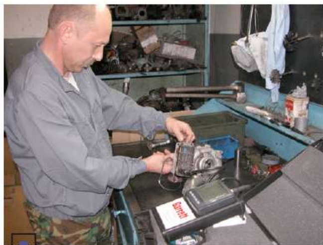
Диагностика электронных турбин возможна только с помощью специализированного тестера
