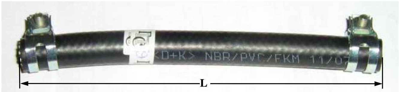
Рис.56. Внешний вид топливопровода низкого давления в сборе с хомутами.
