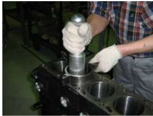
Установка поршневой группы с помощью оправок ЗМ 7853-4306 и 5-ф-98
