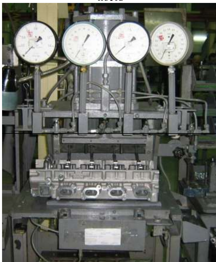
Испытание камер сгорания на герметичность на установке 3М 7871-4389
