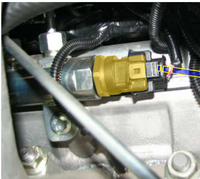
Рис.91. Внешний вид и расположение датчика давления топлива
