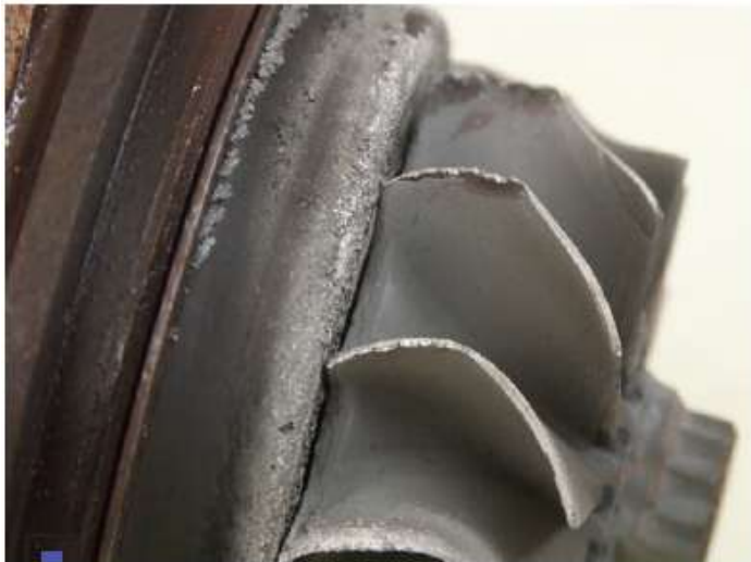
Выкрошенные периферийные кромки лопаток турбинного колеса — верный признак перекручивания
