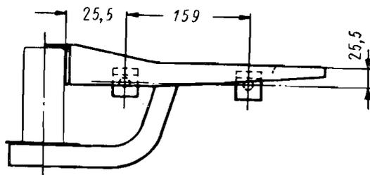
Фиг. 109. Приварка дополнительных деталей для крепления глушителя на автомобилях ГАЗ-69 и ГАЗ-69А (выпуска до второй половины 1957 г.)
